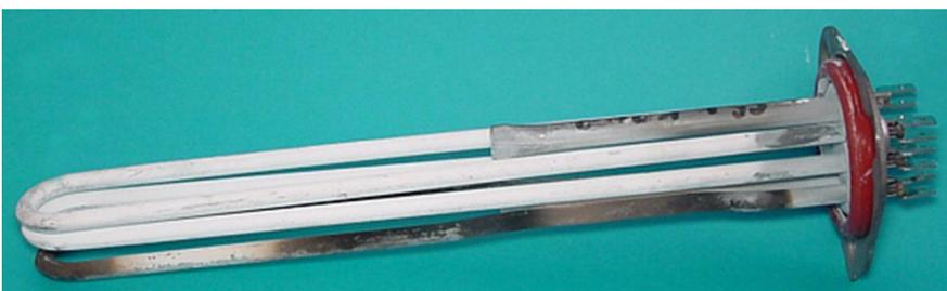
Abbildung 2: Heizelement mit Kalkablagerungen
