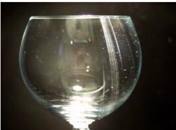
Abbildung 3: Linienkorrosion Quelle: Glastechnische Tagung Leipzig 2003
