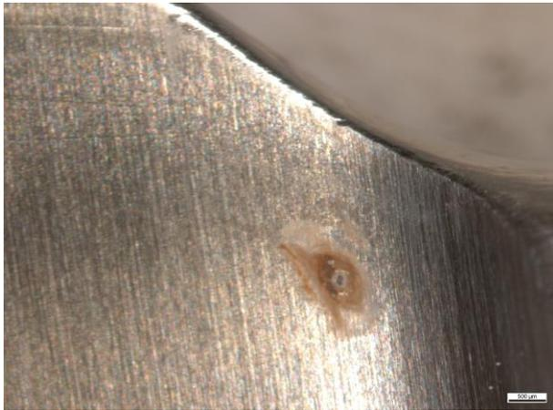
Bild2: Lockkorrosion entsteht z.B. durch hohe Chloridkonzentration.
