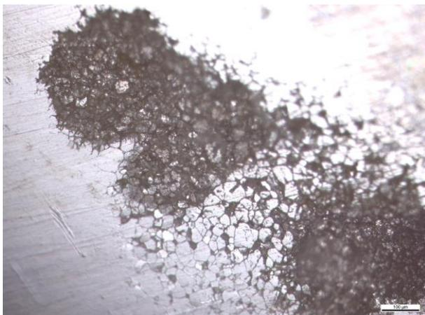
Bild3: Korrosion entlang der kristallinen Korngrenze z.B. aufgrund ungenügender Wärmebehandlung.
